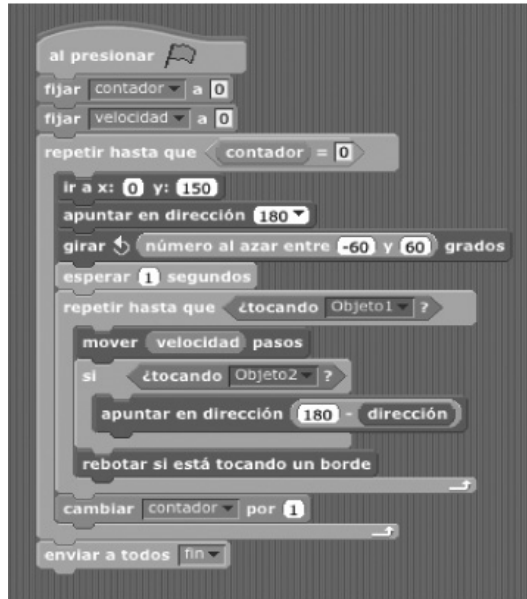
Figura 2. Ejemplo de programa en Scratch : estructura de construcción del programa
