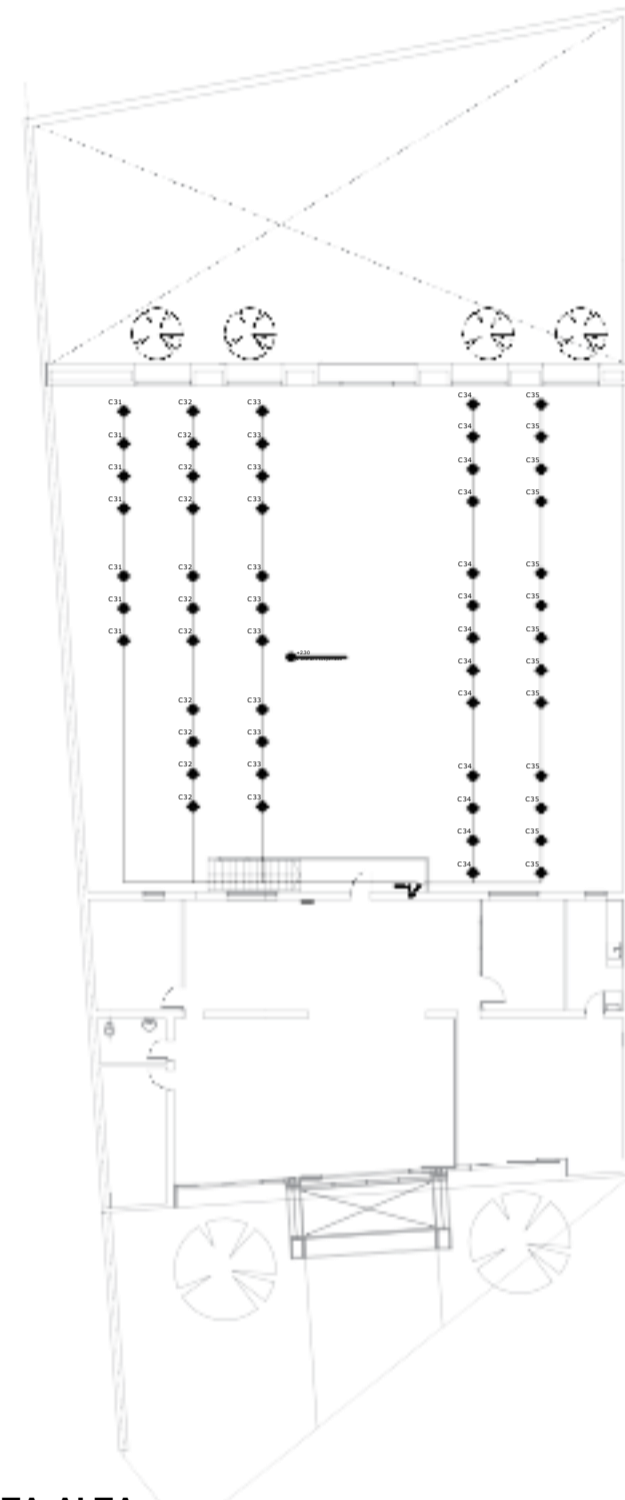
PLANTA ALTA CIRCUITOS BOCAS Y LLAVES
