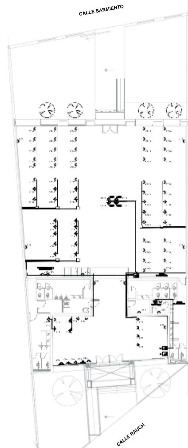
PLANTA BAJA CIRCUITOS TOMAS
