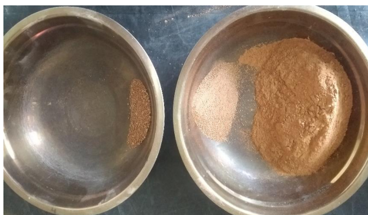
Imagen 9: Muestra extraída a 4,00 m y su respectivo análisis granulométrico.
