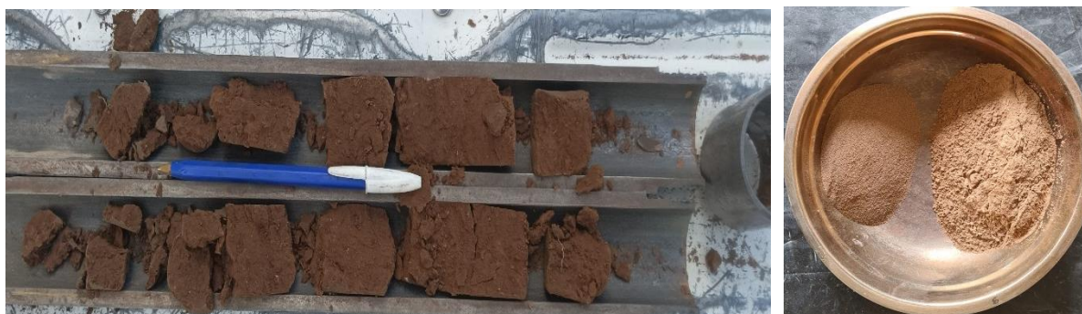
Imagen 8: Muestra extraída a 1,00 m y su respectivo análisis granulométrico.
