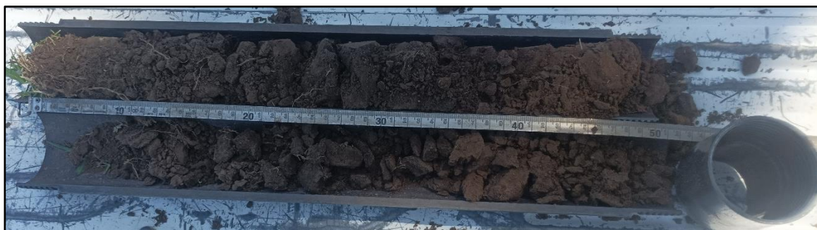
Imagen 6: Muestra extraída de base del sondeo para determinación de capa vegetal.
