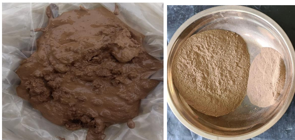
Imagen 10: Muestra extraída a 6,00 m y su respectivo análisis granulométrico.
