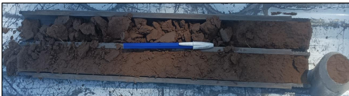
Imagen 6: Muestra extraída de base del sondeo para determinación de capa vegetal.
