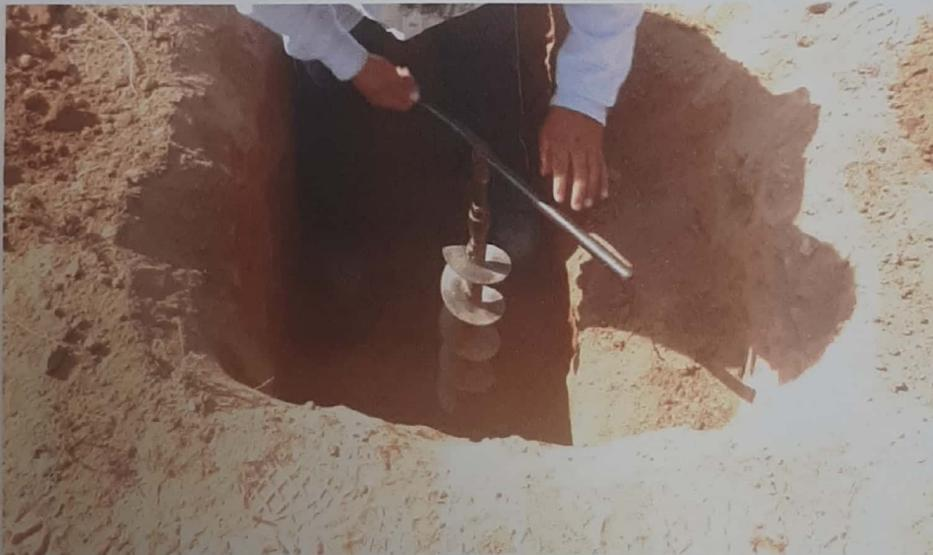
Foto 2: Aquí se muestra el inicio del sondeo S.1 al piso de P.1
