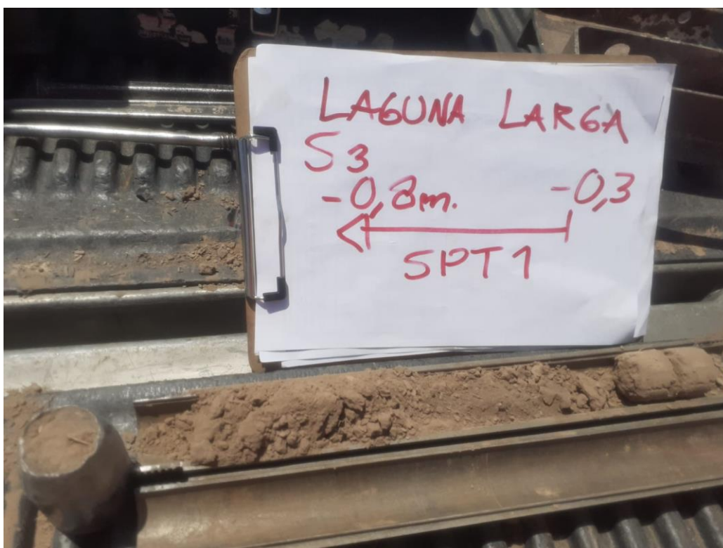
Muestra obtenida con sacabocado de pared gruesa en S3 en el Horizonte II.
