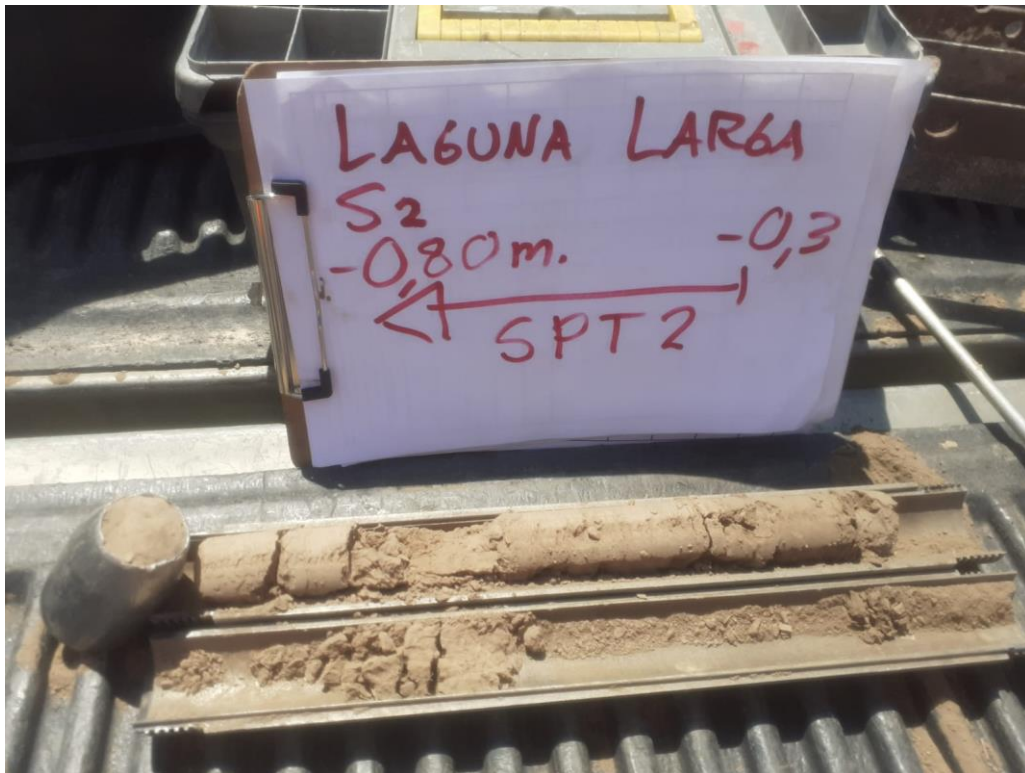
Muestra obtenida con sacabocado de pared gruesa en S2 en el Horizonte II.
