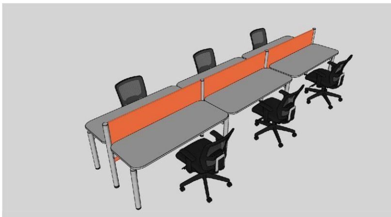
PASO 3: Retiro y Reemplazo de paneles divisorios entelados color naranja existentes.
