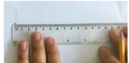
3. Dibujo el punto final según la medida del segmento a trazar.
