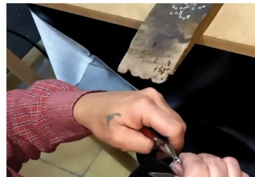
Figura 2. Apertura de eslabones de plata para elaboración de cadena inca.
