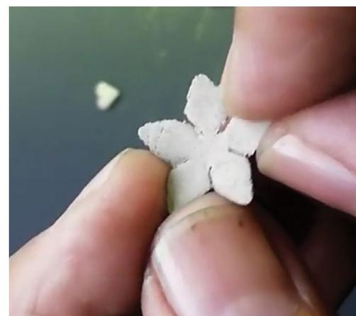
Figura 2. Pieza seca y sin lijar, modelada con arcilla metálica o PMF.
