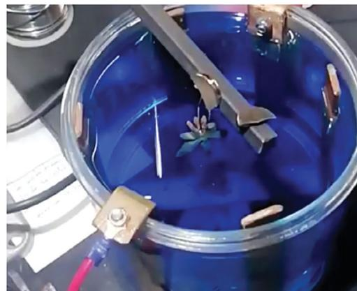
Figura 6. Sumersión de anís estrellado para baño de cobre.
