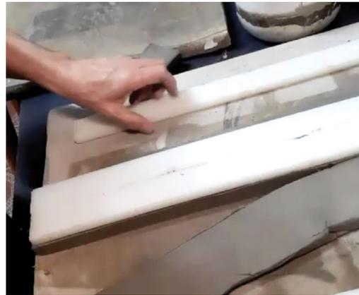
Figura 8. Corte de cinta con cuchilla utilizando placa de acrílico como guía.
