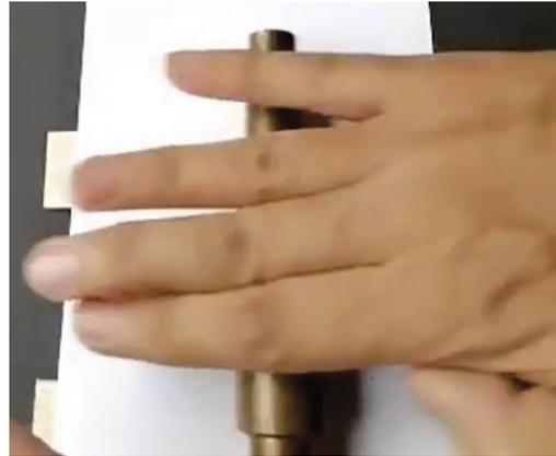
Figura 4. Elaboración de lámina de PMF utilizando un rodillo.
