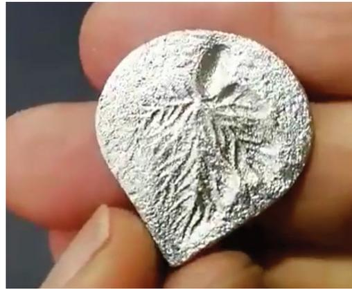
Figura 13. Colgante sin pulir después de proceso de quema.
