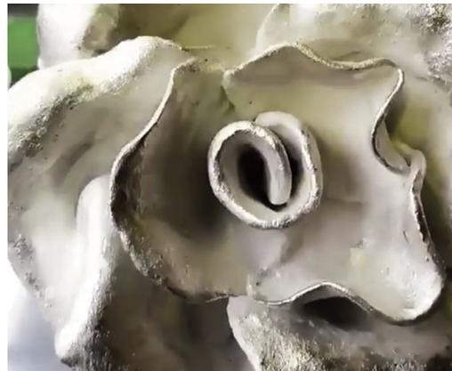
Figura 15. Piezas de barro cubiertas con barbotina de PMF, después de la quema.
