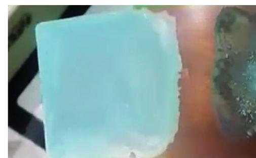
Figura 1. Pátina en lámina de cobre.
