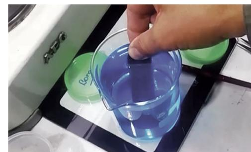
Figura 3. Lámina de acero inmersa en sulfato de cobre.
