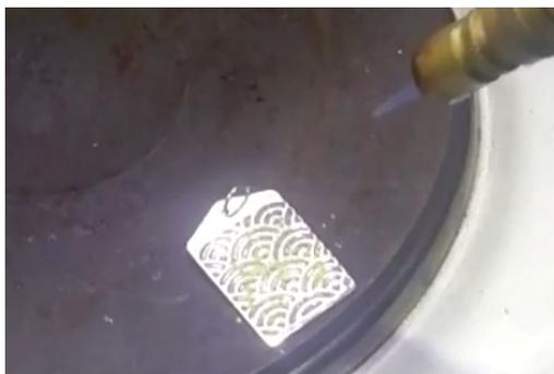
Figura 8. Pátina sobre plata lograda con la quema de azufre
