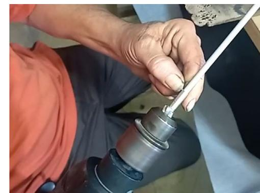
Figura 5. Técnica de empernado de hilo metálico utilizando un taladro.
