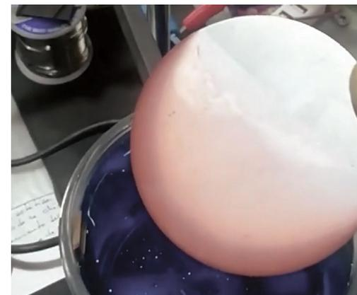
Figura 7. Resultado de inmersión de placa de aluminio en baño de cobre.
