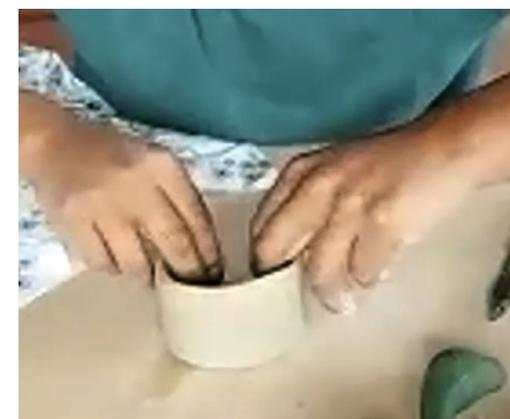
Figura 5. Modelado con arcilla de la pared de la caja cilíndrica del molde.
