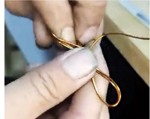
Figura 10. Lazo de alambre de cobre. Inicio de cadena cola de zorro.
