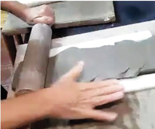
Figura 7. Unificación de placas de arcilla utilizando un rodillo.
