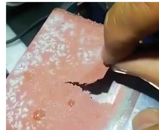
Figura 8. Lámina de cobre desprendida de placa de acero.
