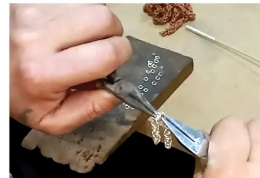
Figura 3. Técnica de colocación de eslabones para construcción de cadena.
