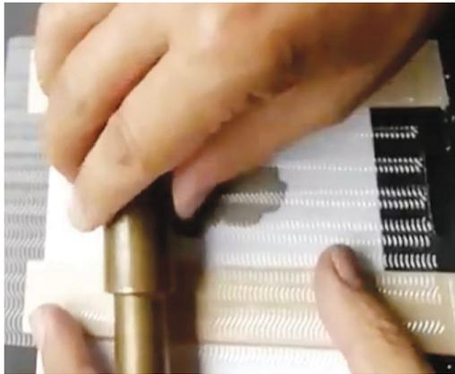
Figura 5. Impresión de textura en lámina de PMF.
