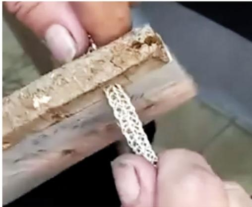
Figura 16. Redondeado de cadena utilizando una hilera.
