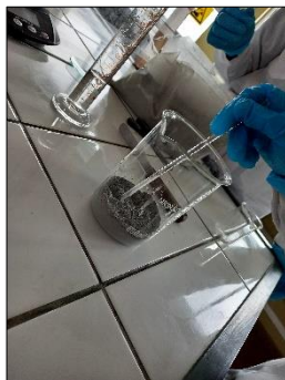
Figura 10. Mezcla de materias primas donde se utiliza relave minero.
