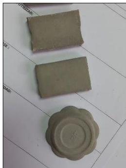
Figura 11. Productos confeccionados con relave y cemento.
