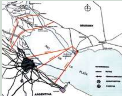
1999. Estudio de trazados posibles para el puente "Carlos Gardel" (desde Zárate o Punta Lara conectando con Nueva Palmira, Punta de los Patos o Colonia)
