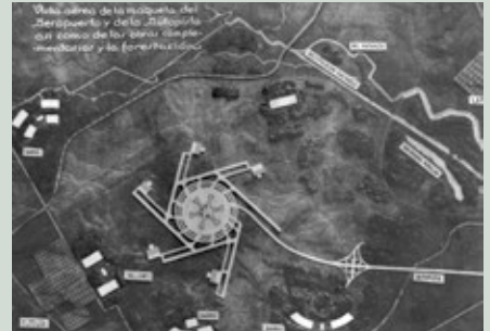
Otra opción desde el MOP: una aeroestación con doce pistas tangenciales a 60°, un núcleo central y la posibilidad de repetir esquemas para futuras ampliaciones
