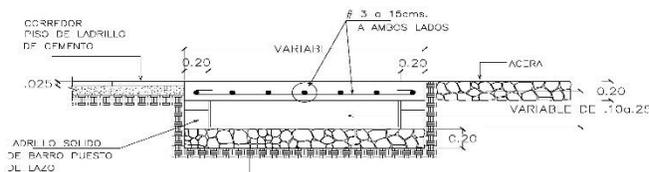
**SECCION TIPICA DE LOSA DE PASO**
