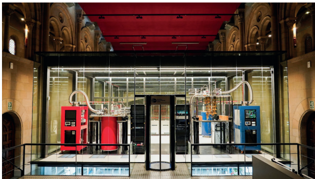
Figura 1. MareNostrum5 Ona, la partición cuántica del superordenador MareNostrum5, instalado en el BSC-CNS
